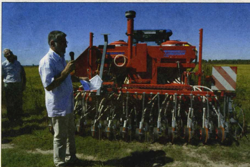
L'utilisation d'un semoir Herriau Turbosem a permis un semis grain à grain et la mise en culture de près de 1,3 ha d'essais sur les terres de Dario Viola au Mas de Cazeneuve.
